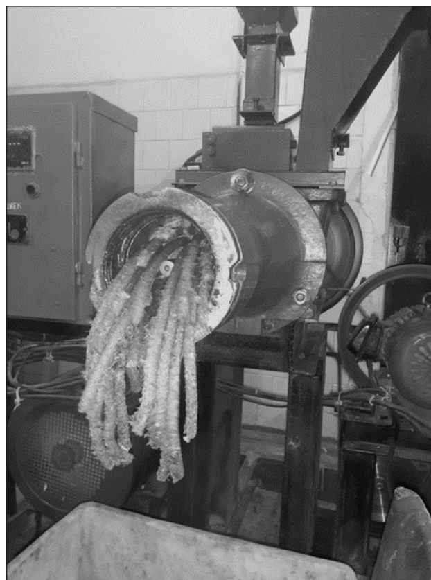
Рис. 3. Процесс гранулирования опытным образцом пресс-гранулятора шнекового типа.
